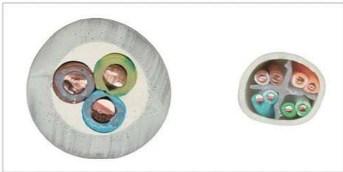
圖1 左邊為2.5mm 2 實心銅質電源線的橫截面；右邊是相同比例的23AWG實心銅質CAT6電纜
